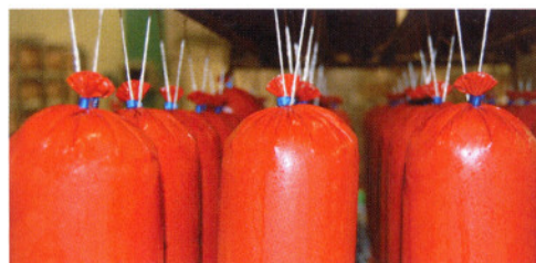
Eine Schlaufe zum Aufhängen der Wurst wird automatisch mit eingeclippt.
